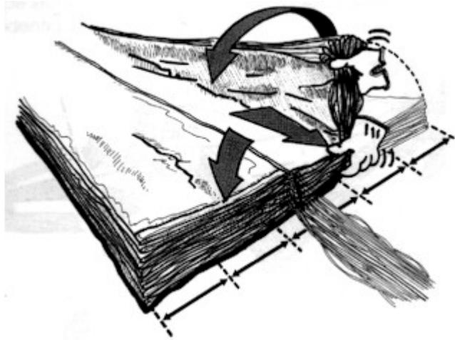
Avec la main gauche, le plieur qui se trouve près du bord d'attaque tient fermement le parachute légèrement à droite des suspentes. Le deuxième tireur prend le parachute à son sommet, sur le même axe, et exerce une tension sur cet axe. Il ne reste alors qu'à basculer la partie droite sur cet axe. Rabattez cette partie sur elle-même.
